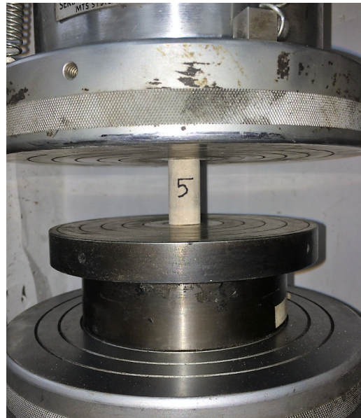
(d) Sandstone Core Prepared for UCS Testing
