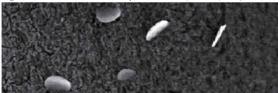
**Figura 5.** Nanoflores de  $\text{TiO}_2$  com 2 μm de diâmetro (XU et al., 2003)
