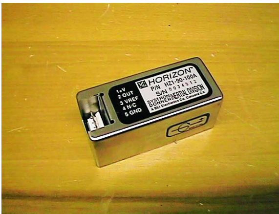
Figure 3.5.10 BEI GyroChip™ Horizon (angular rate sensor)
