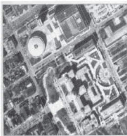
Figura 10. Ortofoto Verdadeira gerada a partir de um DSM com GSD igual a 30 cm
