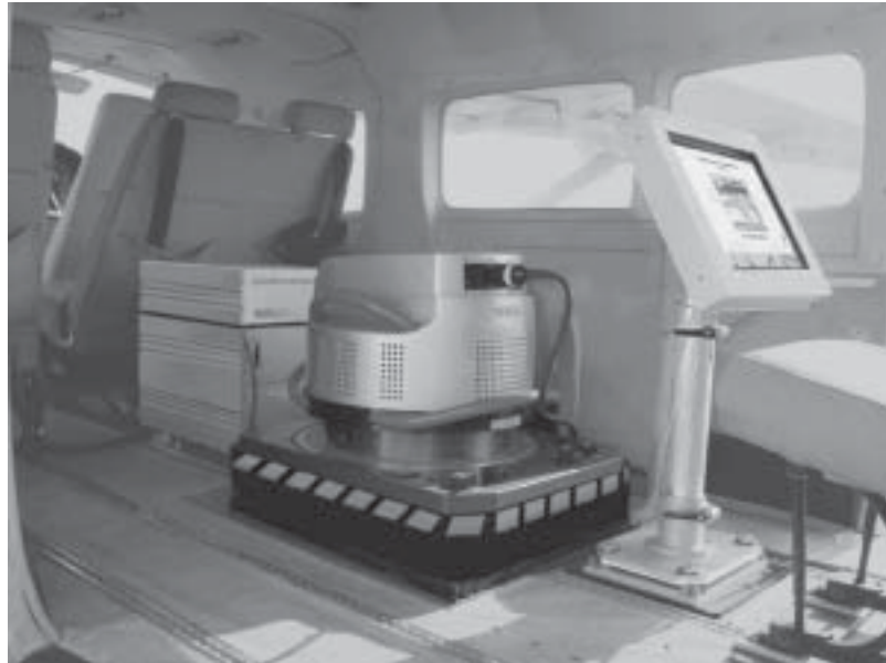
Figura 3. Montagem da câmara aérea digital ADS40 em uma aeronave
