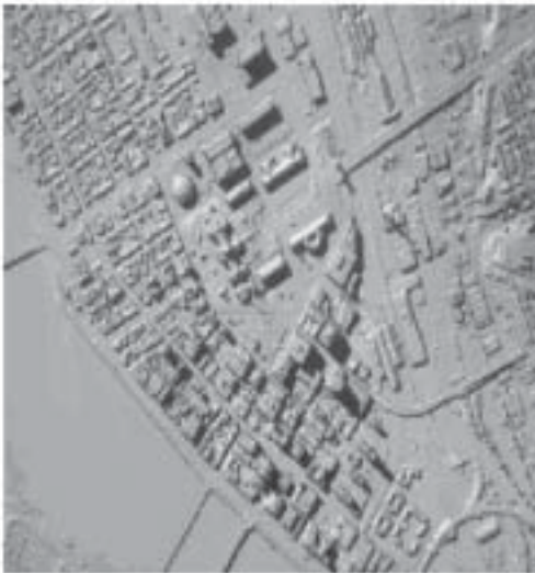
Figura 9. DSM derivado de uma imagem digital da câmara ADS40 com GDS igual a 30 cm
