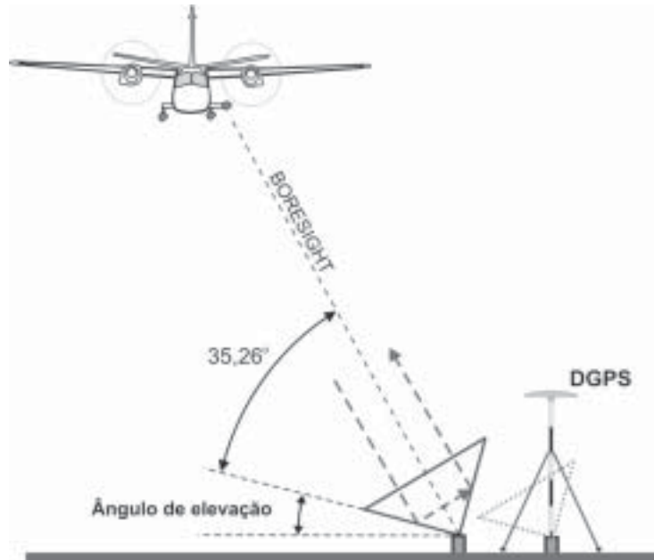
Figura 4. Instalação dos refletores de canto
