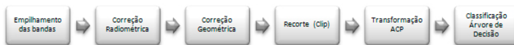
Figura 2 - Fluxograma das etapas de processamento das imagens Landsat 5 (TM) para classificação automática de áreas afetadas por incêndios florestais
