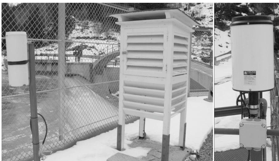
Figura 1. A la izquierda podemos ver la garita meteorológica y el pluviómetro manual de la estación meteorológica de Ransol (1645m). El pluviómetro manual tipo Hellmann ha sido sustituido por aparatos automáticos modernos como se observa a la derecha.
