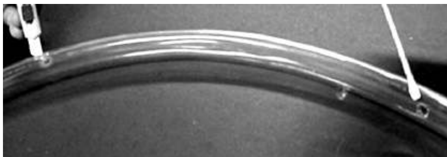
Figura 2. Orifícios no tubo de 3/4”
