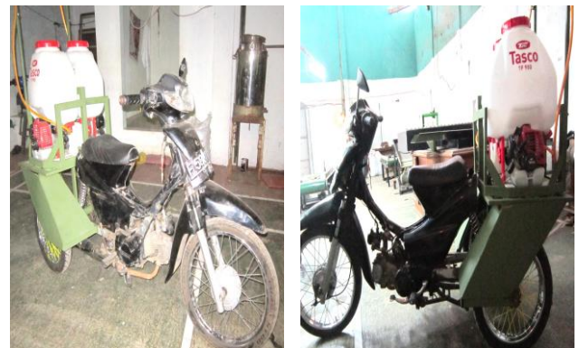
Gambar 11 Mobile sprayer machine (prototipe B) hasil modifikasi.
