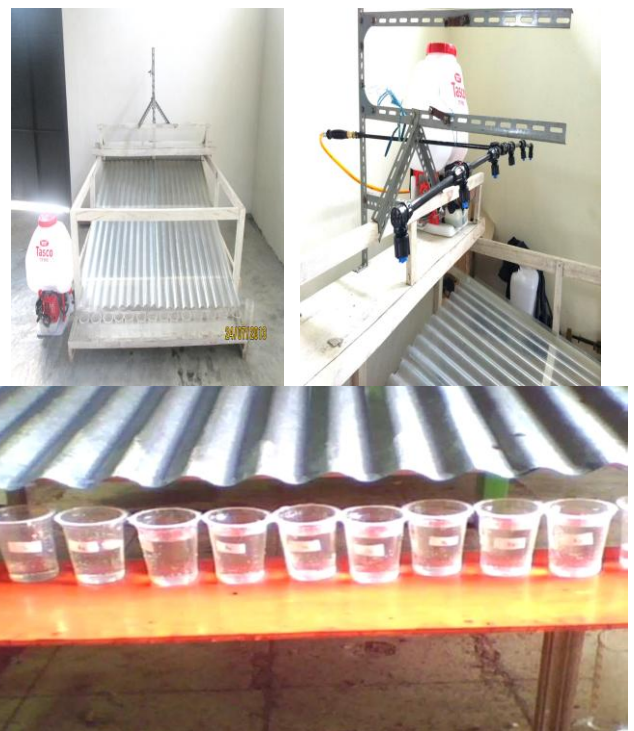
Gambar 4 Pengujian efektivitas penyemprotan menggunakan sprayer dengan nosel berbentuk flat fan dan cone .
