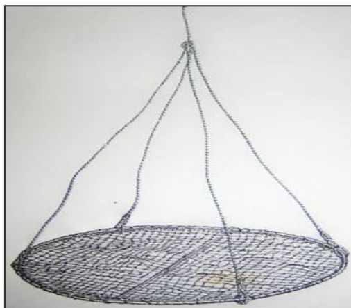
Gambar 2 Perangkap krendet untuk menangkap lobster dengan ukuran diameter bingkai: 80 – 100 cm (Sumber : Thomas 1973).
