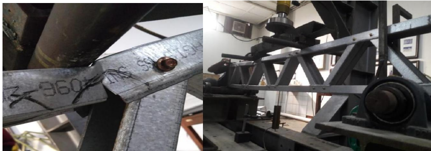
Gambar 2. pola kegagalan balok profil C sentris B-1
