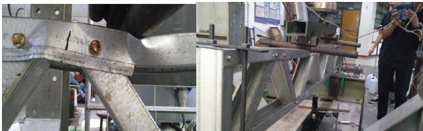
Gambar 3. pola kegagalan balok profil C sentris B-2
