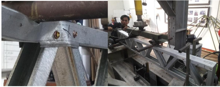
Gambar 4. pola kegagalan balok profil C sentris B-3
