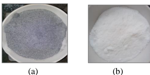
Gambar 1. Abu sekam padi (a) dan serbuk silika hasil isolasi (b).
