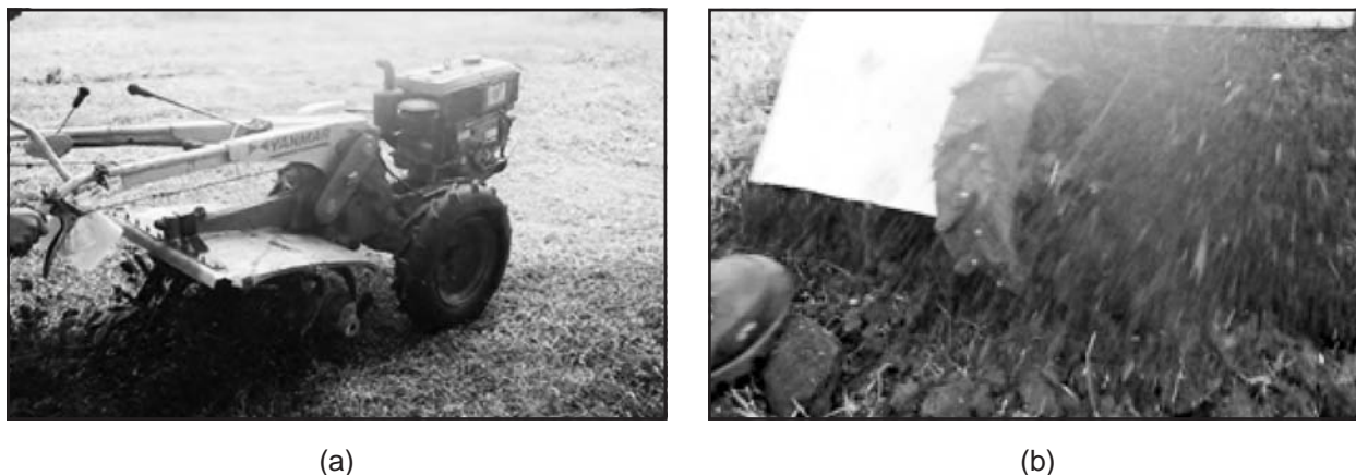
Gambar 3. Pengujian rotary tiller pada tanah keras (a), tanah gembur (b).
