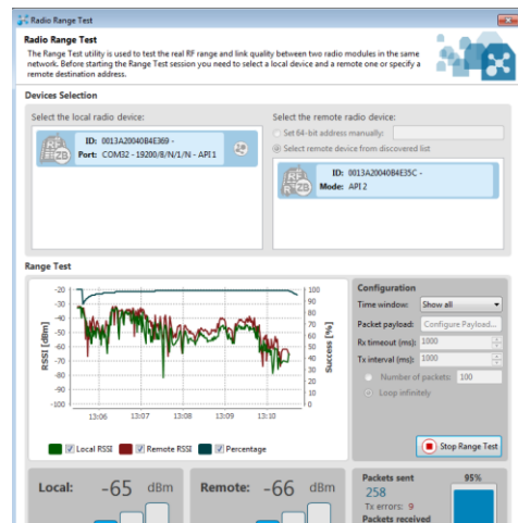
Gambar 10. Tampilan pengujian sinyal pada jarak 58,18 meter
