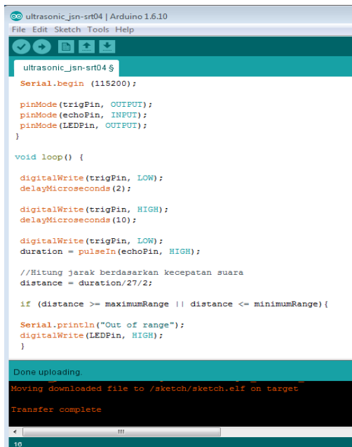
Gambar 12. Sketch komunikasi sensor terhadap Arduino-Uno
