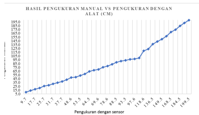
Gambar 23. Grafik perbandingan hasil pengukuran manual dan alat
