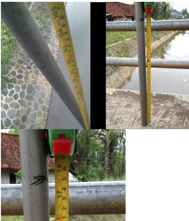
Gambar 22. Proses Kalibrasi pengujian tinggi air
