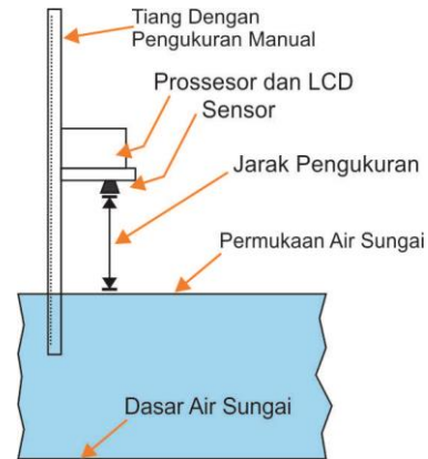
Gambar 8. Model sistem dan ilustrasi implementasi sistem
