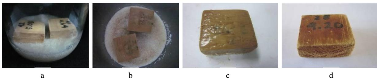
Gambar 4 Tampilan tunggul karet (a) contoh uji kayu hari ke-0, (b) contoh uji kayu minggu ke-12, (c) isolat bakteri yang menyelimuti permukaan contoh uji kayu, dan (d) contoh uji kayu yang sudah dibersihkan dari isolat bakteri
