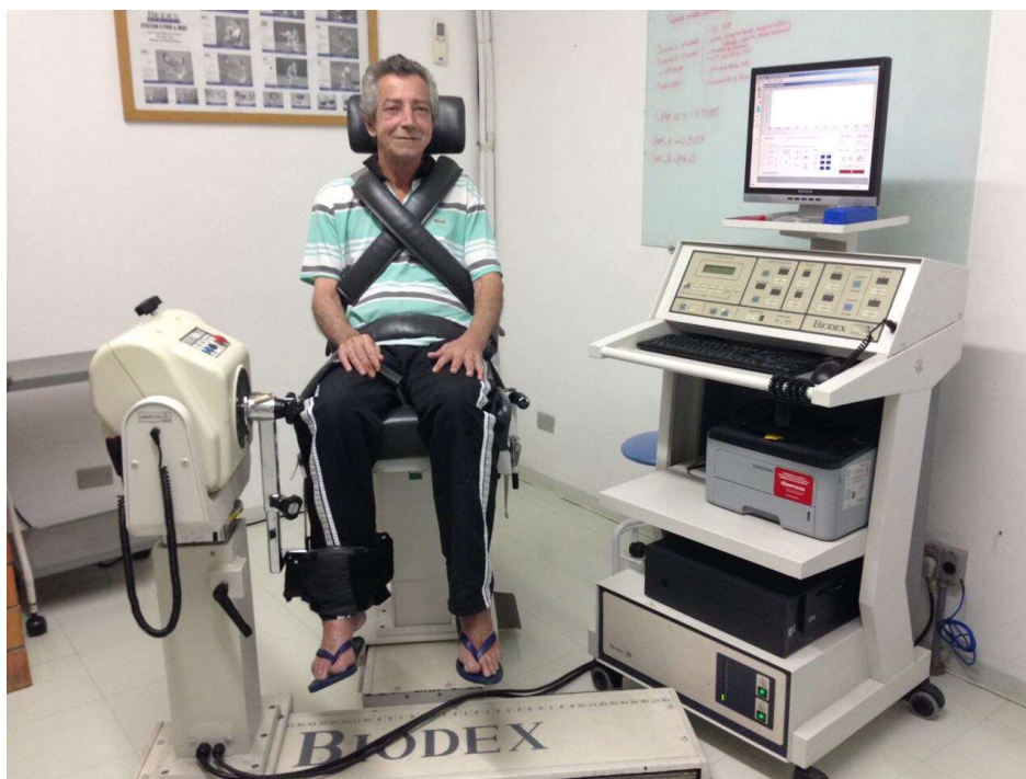
Figura 2 – Posicionamento do paciente na cadeira do dinamômetro isocinético Biodex System 3.
