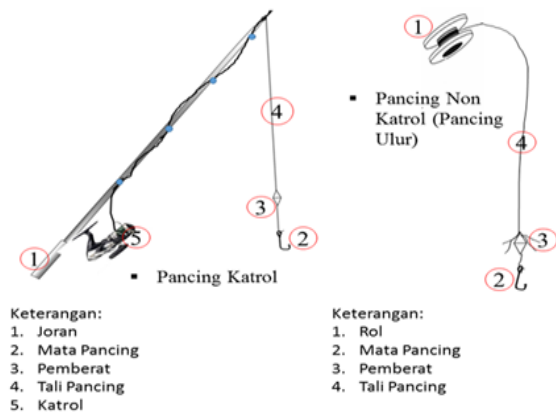
Gambar 6. Kontruksi unit teknologi penangkapan ikan kurau unggulan (pancing).
