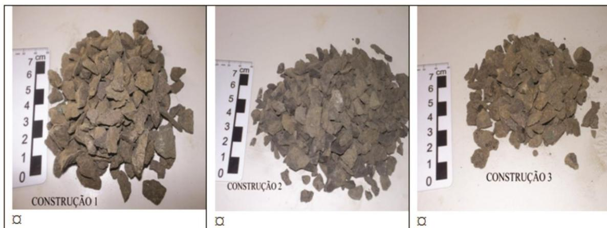
Figura 3. Basaltos britados utilizados nas três construções do bairro Jardim do Rosário, Ituiutaba/MG.
