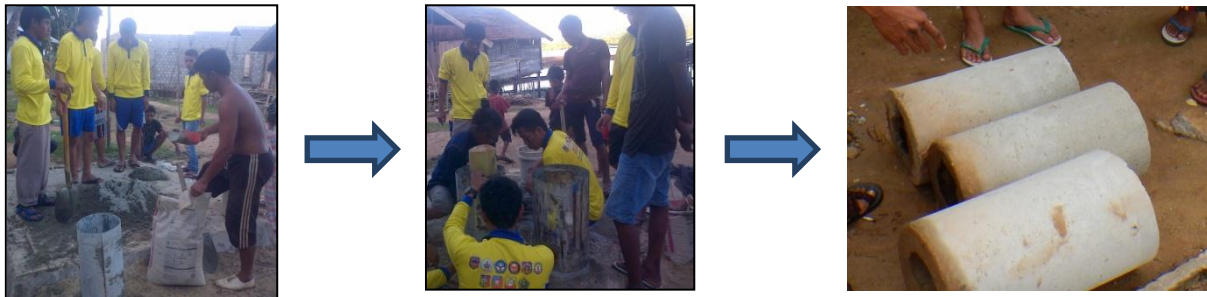
Gambar 3. Urutan kerja pembuatan karang buatan berbentuk cincin
