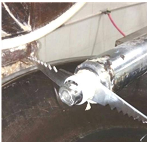
Gambar 2. Bentuk pisau yang digunakan pada mesin pencacah daging
