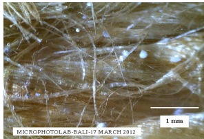
Gambar 14. Photo mikro komposit hybrid serat sisal dan karung goni dengan perbandingan serat 20% : 10%.
