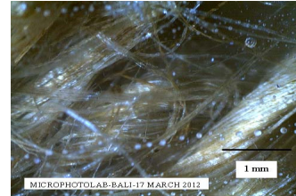
Gambar 16. Photo mikro komposit hybrid serat sisal dan karung goni dengan perbandingan serat 10% : 20%.
