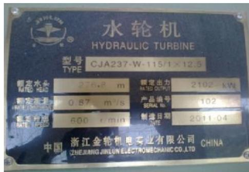
Gambar: 3 spesifikasi turbin yang terpasang
