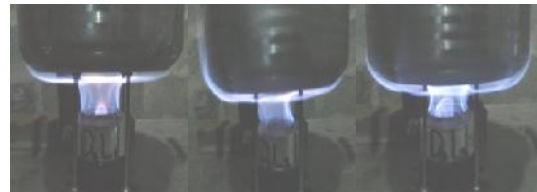
Gambar 4.4 kompor alkohol diameter inner pipe 1 1/2 inchi dengan variasi jumlah jet hole 8 buah, 12 buah , 16 buah
