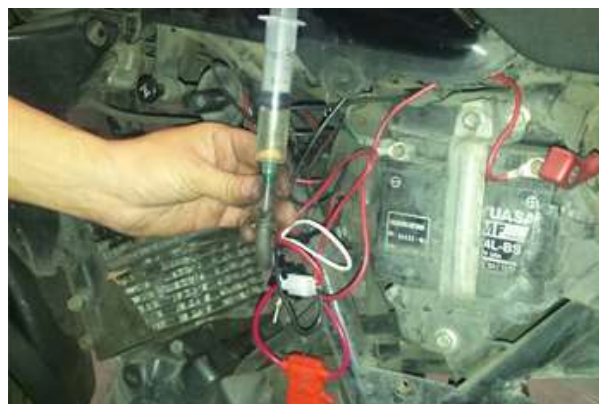
Figura 4. Montaje del dispositivo dosificador. Conexión de la manguera dosificadora al carburador.
