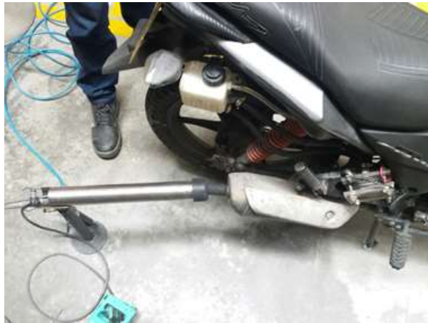
Figura 11. Montaje de sensor JB-SPI en el tubo de escape de la motocicleta.
