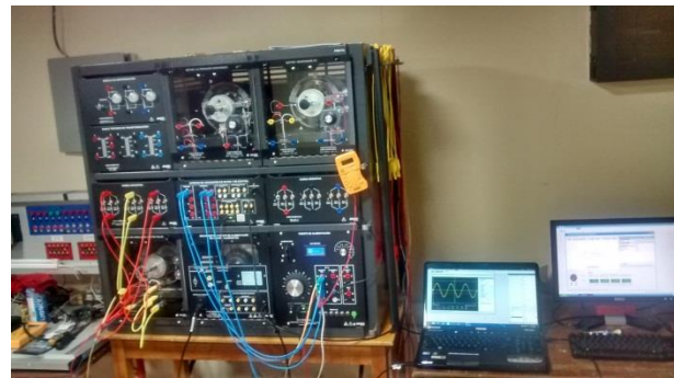
Figura 1. Estación de pruebas LabVolt con interface a computador. Fuente: elaboración propia.
