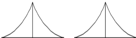
Figura 11. Momentos en la fase de construcción de los voladizos desde los pilares. Fuente. Elaboración propia.
