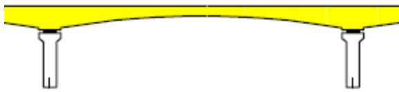
Figura 15. Detalle típico de la continuidad de la estructura de los puentes de segunda generación. Fuente. SETRA.
