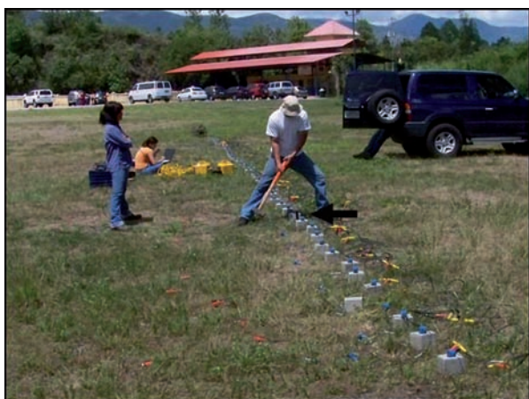
FIGURA 4. Tendido sísmico para la adquisición de las ondas transversales en los conglomerados de la Fm. Sabaneta.
