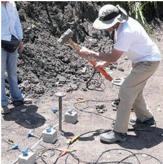
FIGURA 2. Bloques con sus respectivos geófonos insertados y el proceso de introducir la punta de eje.
