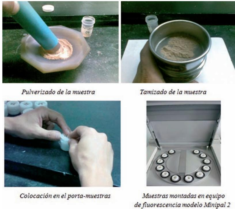
FIGURA 7. Preparación de muestras para fluorescencia de rayos-X.
