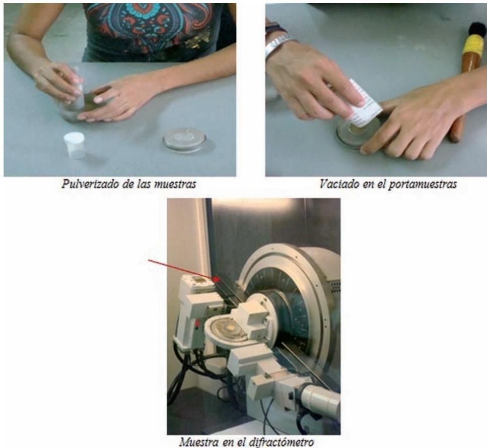
FIGURA 6. Procedimiento para la preparación de muestras para difracción de rayos X.
