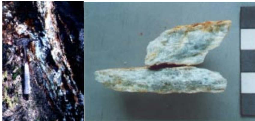
FIGURA 2. a) Aspecto en campo de las venas con alófana, cortando lodolitas de la Formación Paja; b) agregados granulares de alófana de colores azul claro, en muestra de mano (cada división de la escala corresponde a 1 cm).
