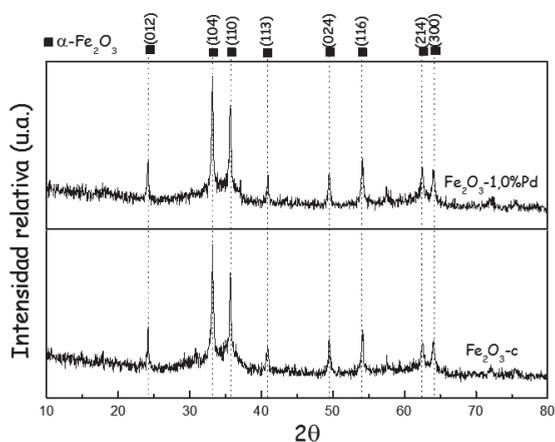
**Figura 2.** Efecto del dopante Pd en los difractogramas de las muestras basadas en nanopartículas de óxido de Fe. Muestra Fe<sub>2</sub>O<sub>3</sub> -1,0%p de Pd calcinada (arriba). Muestra Fe<sub>2</sub>O<sub>3</sub>- c (abajo).
