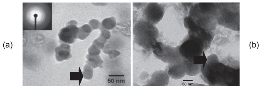
**Figura 3.** a: Microfotografía TEM de las nanopartículas de  $Fe_2O_3$ -c sin dopar calcinadas a  $400^\circ C$ .
