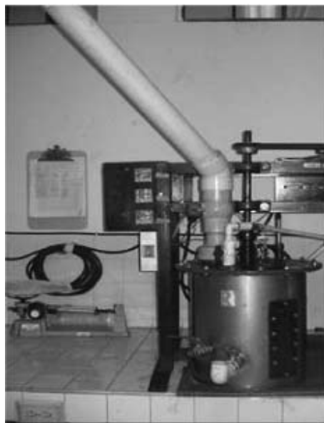
Figura 1. Sistema del biorreactor hidrolítico.
