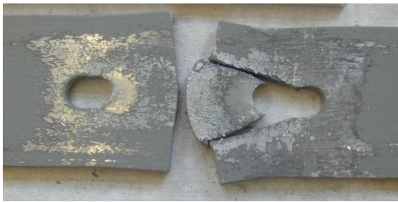
Şekil 7. Deney sonucunda çelikte kayma sonucu kopma ( t_{Al}=10.0 mm)
