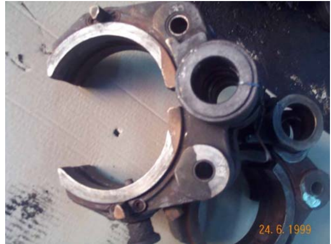
Şekil 2. Aşınmış ve korozyona uğramış durumdaki kullanılmış bir kalıp kolu
