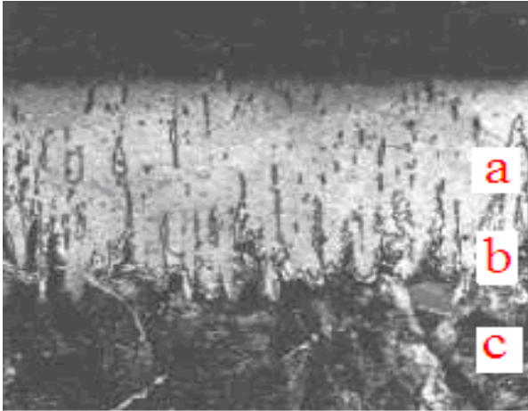
Şekil 3. Borlanan malzemenin kesitine bakıldığında, yapının üç bölgeden oluştuğu görülür. a) FeB ve Fe 2 B içeren borür katmanı, b) Geçiş bölgesi, c) Matris
