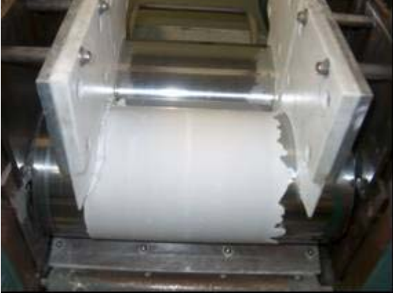
Şekil 4. İki silindirik mil içeren kalender aleti ve MDF çimento üretimi
