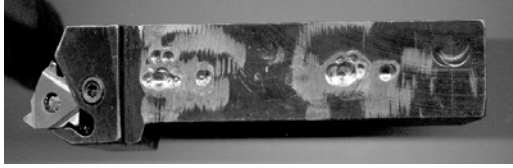
Şekil 4. Vida takımının resmi (Kesici plaketi mekanik olarak tespit edilmiştir)
