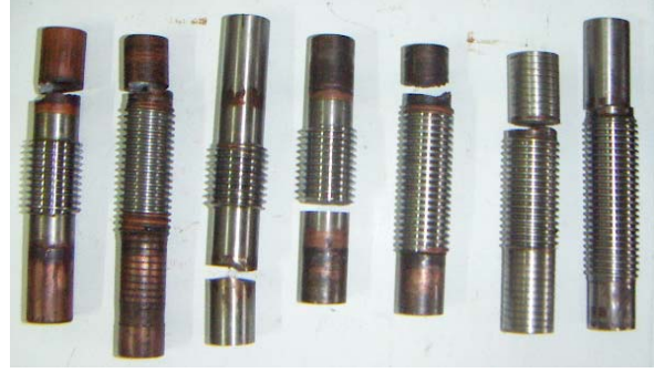
Şekil 8. Denemeler sırasında vidalı kısımlar haricindeki bölgelerden kırılan numuneler
