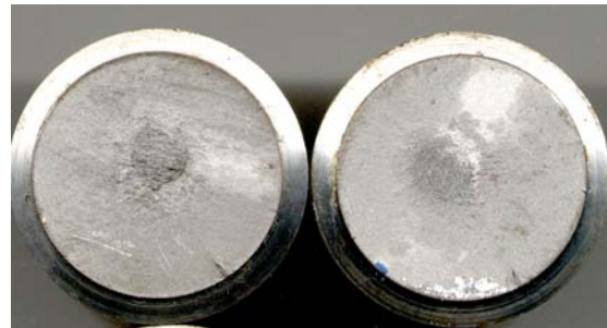
Şekil 12. Çentikli Numune kırık görünüşü
