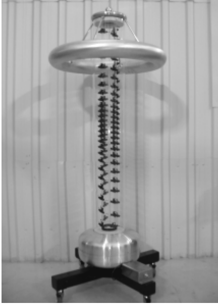
Şekil 4. Tasarlanıp gerçekleştirilen standart gerilim bölücü
