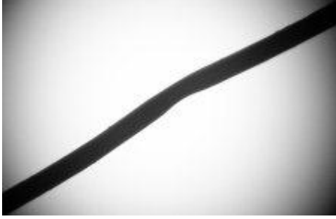
Şekil 1. 50 µm kadar ezilmiş bir telin fotoğrafı
