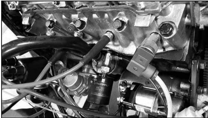
Figura 4: sensor de presión Danfoss MBS 3000 instalado en el orificio de la bujía de encendido del cilindro n°4.
