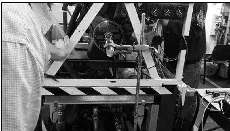
Figura 3: disco graduado instalado sobre la polea del cigüeñal y puntero laser midiendo la posición angular del PMS para fijación del sensor.
