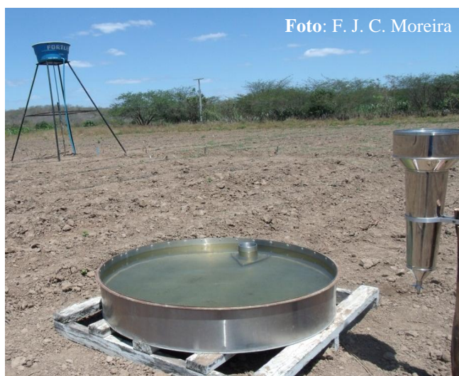
Figura 3. Tanque classe A, instalado no centro do experimento, para medições diárias de evaporação.
