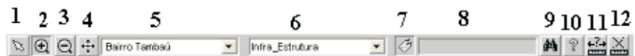
Figura 3. Botões de interação com mapa, Domínios, Mapas Temáticos, Informação, Pesquisa, Ajuda, Distância e Desmarca distância..
