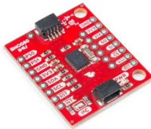
Figura 20: Sensor BNO080 y el sistema de evaluación
