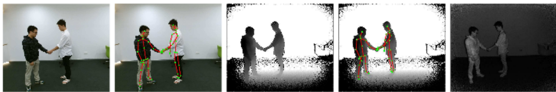
Figura 4.7: Ejemplo de la información proporcionada por la base de datos. Se incluye información RGB, RGB+joints, depth, depth+joints e información infrarroja [13, 14].
