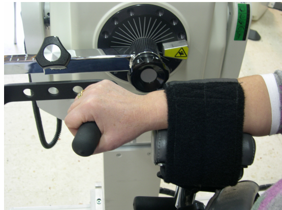
Figura 8. Estabilización mediante correas y alineación del eje de la muñeca con el eje del dinamómetro tomando como referencia ósea la apófisis estiloides cubital 65 .
