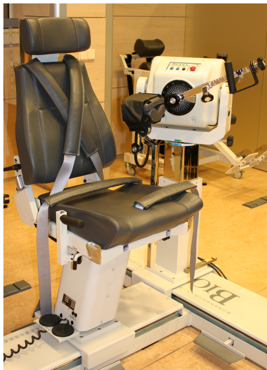
Figura 16. Sillón regulable con sistema de correas almohadilladas de estabilización
