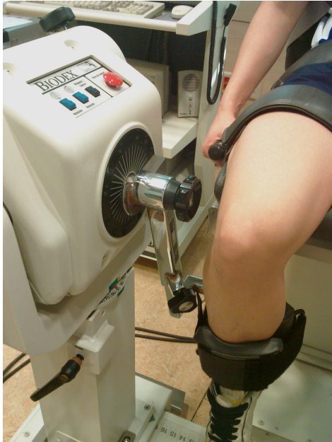
Figura 7. Estabilización mediante correas y alineación del eje de la rodilla con el eje del dinamómetro tomando como referencia ósea el epicóndilo externo femoral 65 .
