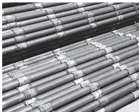
Figura 1. Tubos manguito. Válvulas cada 50 cm (cortesía de CDE Arquitectura).
