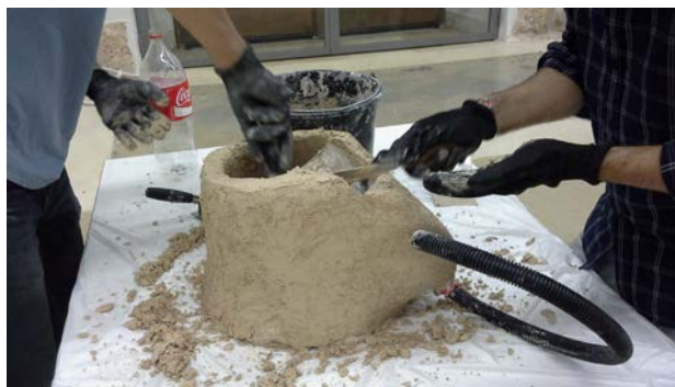
Fig. 3. Prototipo de taza separativa con enfoque de género autoconstruida con material reciclado.
