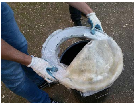
Fig. 2. Prototipo de taza separativa autoconstruida aplicada a Turquía.
