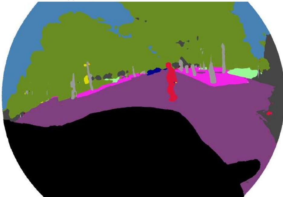
(b) Imagen segmentada con ERFNet con decoder piramidal
