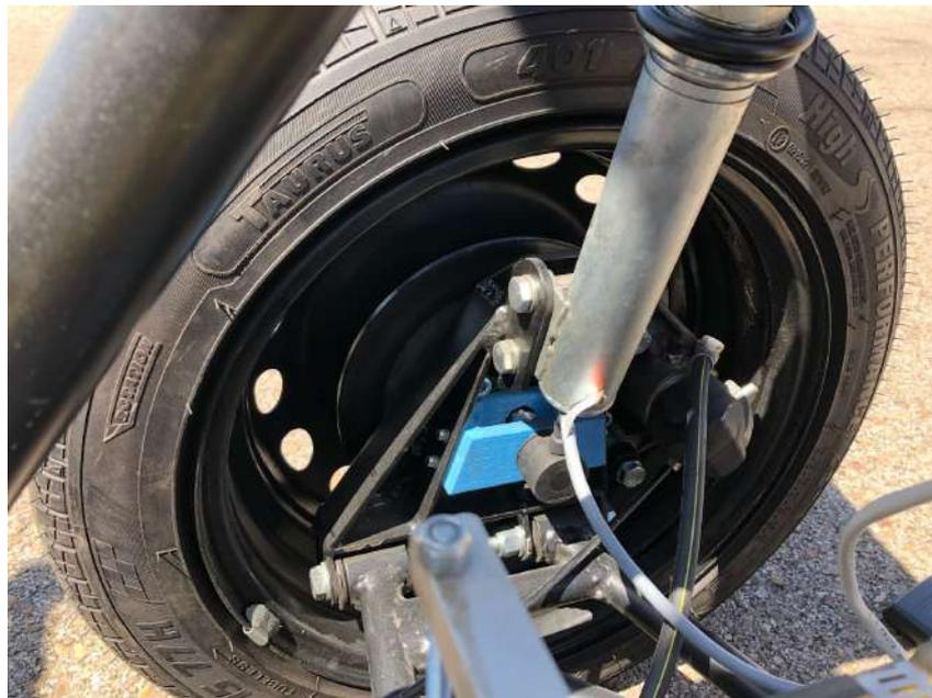
Figura B.7: Encoders incorporados en la rueda mediante pieza 3D impresa
