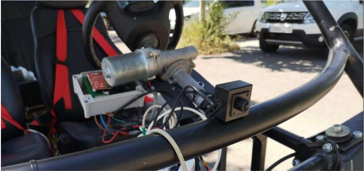
Figura 7.21: Cámara integrada en el prototipo de SmartElderlyCar
