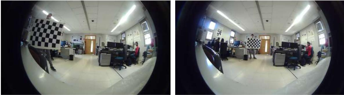
(a) Ejemplo de imagen utilizada para la calibración 1 (b) Ejemplo de imagen utilizada para la calibración 2
