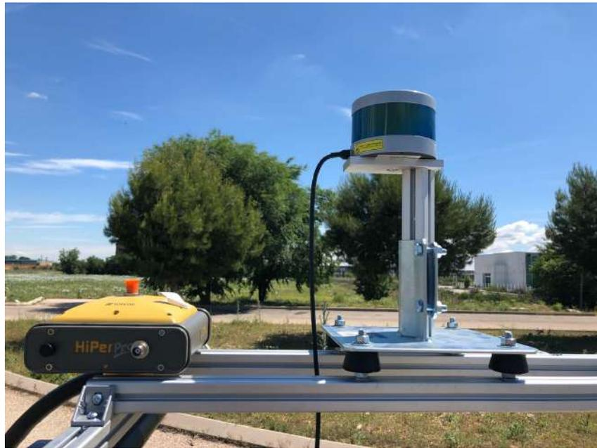
Figura B.3: Receptor GNSS y lidar
