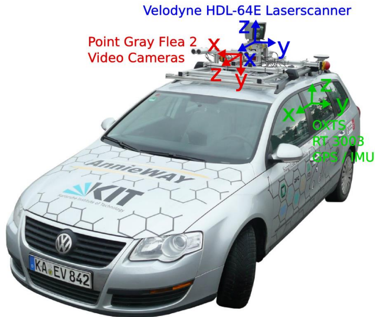
Ilustración 5 - Sistema de coordenadas de KITTI
