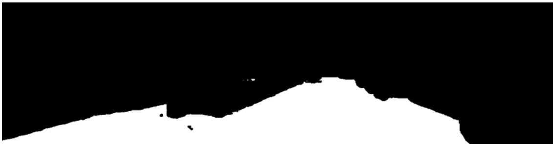
Ilustración 24 - Imagen con carretera extraída.
