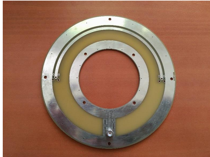
Ilustración 34 PCB para la relación de aspecto y conexión de señal
