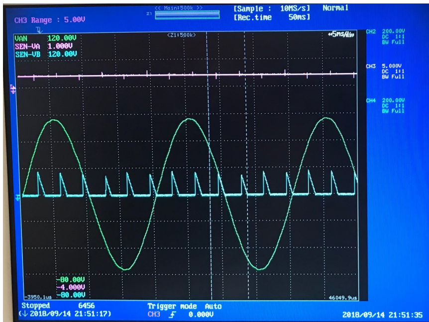
Figura 140. Prueba realizada modificando en disparo del tiristor
